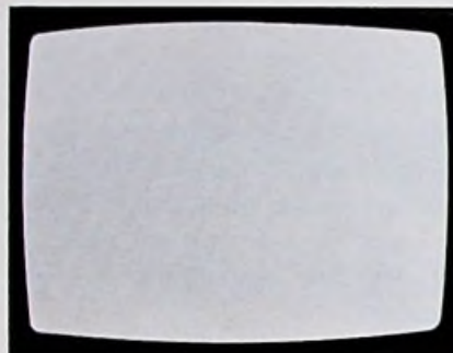
Bild 35. Ist der Bildschirm hell und ohne Rauschen, liegt der Fehler im ZF-Verstärker (Saba)
